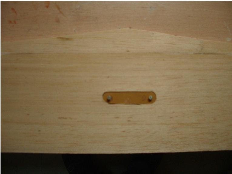
Dejaremos alojadas unas tuercas autoempotrables, dos en la parte superior y otras dos en la parte inferior, y construiremos unas piezas de fibra de vidrio o baquelita para unir las distintas partes del estabilizador.
