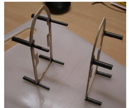
Como el fuselaje también se desmonta, vamos a cortar dos cuadernas de contrachapado de 1mm. 8 trozos de fibra de carbono de 6mm y 4 trozos de fibra de 4mm, que discurrirán por el interior de los tubos de 6.
