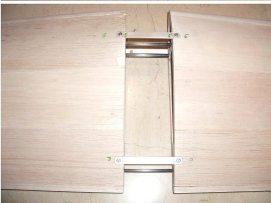
Posteriormente, cortaremos la fibra de carbono que sobra y cortaremos dos varillas de fibra de 6mm y una varilla de 4mm, que introduciremos en el interior de las varillas de 8 y 6mm, respectivamente, y que han quedado en el interior de las semialas.
