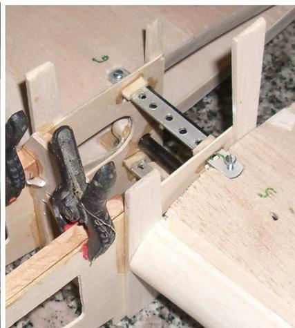
En la fotografía vemos el montaje del morro. Pegaremos dos trozos de tubo de fibra de carbono de 8mm, coincidiendo con los taladros que llevan los refuerzos de contrachapado. En su interior lleva una varilla de fibra de 6mm. De esta forma, al desmontar el ala, todo quedará perfectamente alineado y centrado. También pegamos al fuselaje las pletinas de aluminio, previamente atornilladas al ala.
